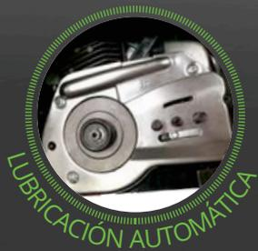
Lubricación de cadena con bomba automática. También incluye sistema de amortiguación Silent-Blocks Plus.
